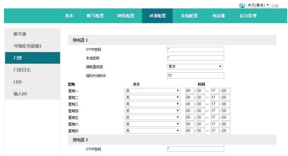
DTMF 密码远程开门,室内和室外通信,室外输入密码来开锁;
