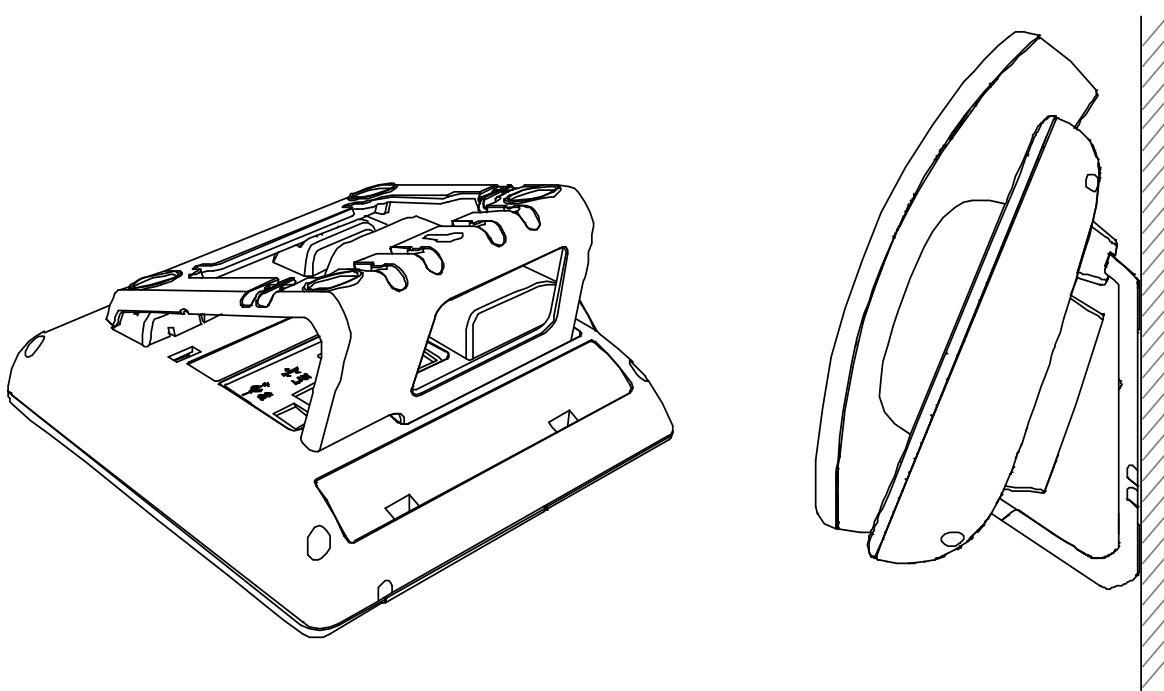
G. 拆卸脚架方法：按 Push 箭头方向按下脚架弹力片，同时按旋转箭头方向用力扳脚架，则可取下脚架，分别为 step1、step2、step3 和 step4。如下图：
