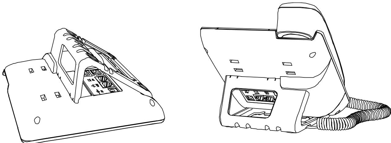
D. 拆卸脚架方法：按下脚架上端弹力片，同时按箭头用力扳脚架，则可取下脚架。如下图：
