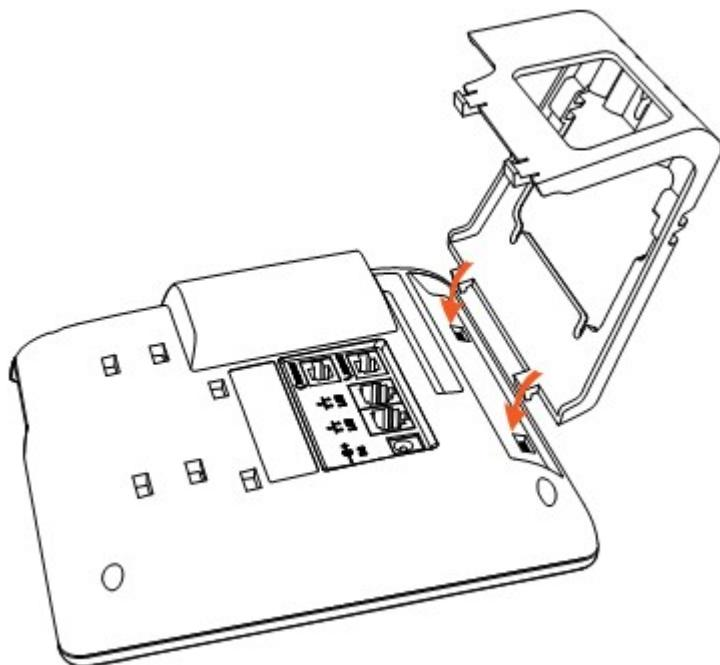
B. 按箭头方向按压脚架，使脚架的另一边扣进主机底壳的槽内，如下图所示：
