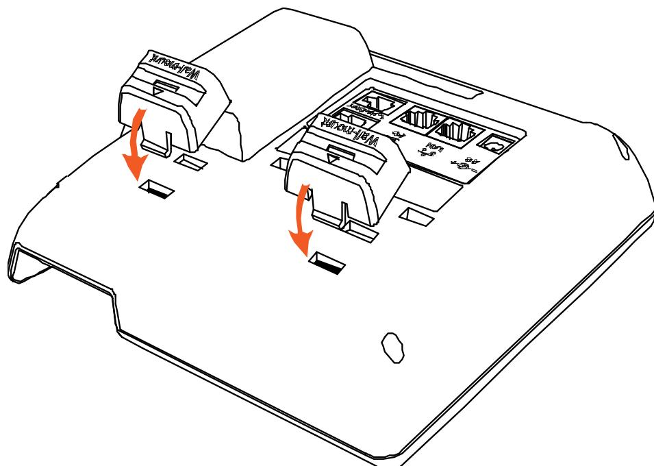
B. 按箭头方向按压挂墙脚架，使脚架的另一边扣进主机底壳的槽内，如下图所示：
