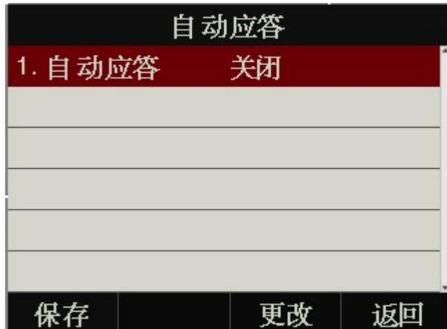
自动应答功能开启后，待机界面状态栏显示自动应答图标 **A**。
