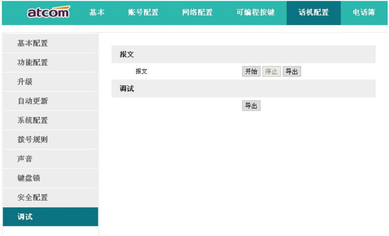
要对话机进行抓包分析，可以点击报文选项中的“开始”按钮进行抓包，抓包结束后，按“停止”按钮结束抓包，之后通过“导出”按钮就可以通过网页下载抓包文件了。
