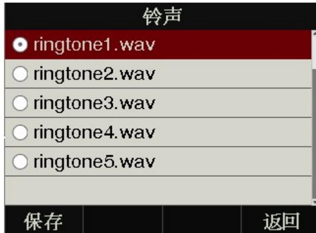
正在使用的铃声，会有一个黑点在对应的铃声的圆圈中，按
